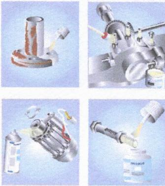
WEICON사의 나사(산) 고착방지제인 Anti-Seize는 나산(산) 표면을 보호하고 고착을 방지하며 윤활 작용을 하는 제품입니다. 특히, 많은 스트레스와 고온에 노출된 부품에 폭 넓게 사용됩니다. 기존의 강유 기반의 고착방지제나 구리스 등이 해결할 수 없는 열악한 작업 조건에 사용할 수 있도록 유황 성분이 거의 없는 합성유 기반으로 개발되었으며, 200-250°C 사이에서 오일 성분이 휘발되어 잔여물이 남지 않습니다. 이러한 특성은 특히 스텐레스 강(VA)의 스트레스 부식 균열(stress-corrosion cracking) 방지에 매우 중요합니다.
